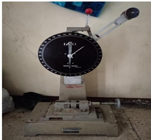
Gambar 2. Alat uji Impak metode izod
