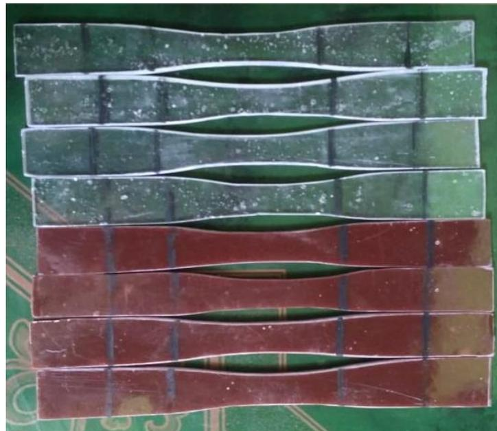
Gambar 5. Spesimen Uji Tarik
